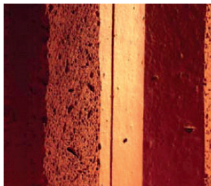
Рис. 6. Поризованная структура черепка
